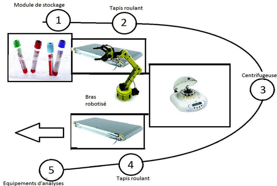
Le laborantin dépose les échantillons sanguins dans un module de stockage (1).
