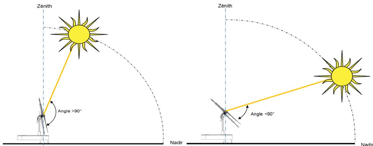
2. Fonctionnement suivant la longitude. En fonction de la longitude du soleil, entre l'Est et l'Ouest, la carte électronique commande l'orientation des panneaux photovoltaïques jusqu'à atteindre la position du soleil selon le modèle suivant, si le soleil est en :
